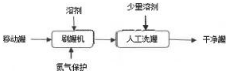
图3.4-2 脏罐清洗工艺流程图
