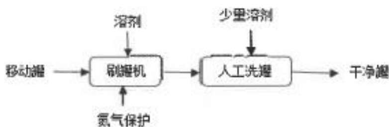
图2.2-2 脏罐清洗工艺流程图
